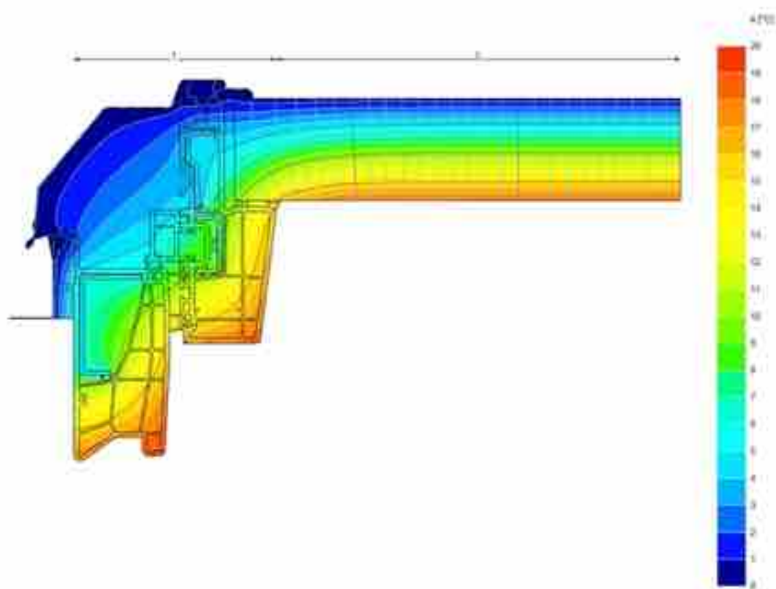
Izotermy, strumień ciepły, temperatury. Przekrój ramy: B-B / panel izolacyjny 48mm. 1- 95mm, 2 -190mm.
