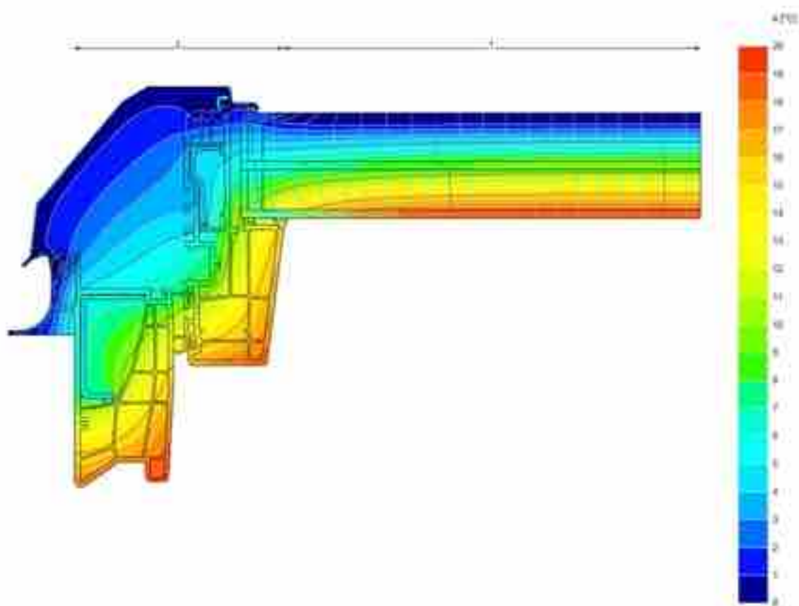
Izotermy, strumień cieplny, temperatury. Przekrój ramy: ościeżnica-skrzydło (A-A)/ szyba zespolona 4|18|4|18|4, ramka TGI, U_g=0,5W/(m^2K) . 1- 95mm, 2 -190mm.
