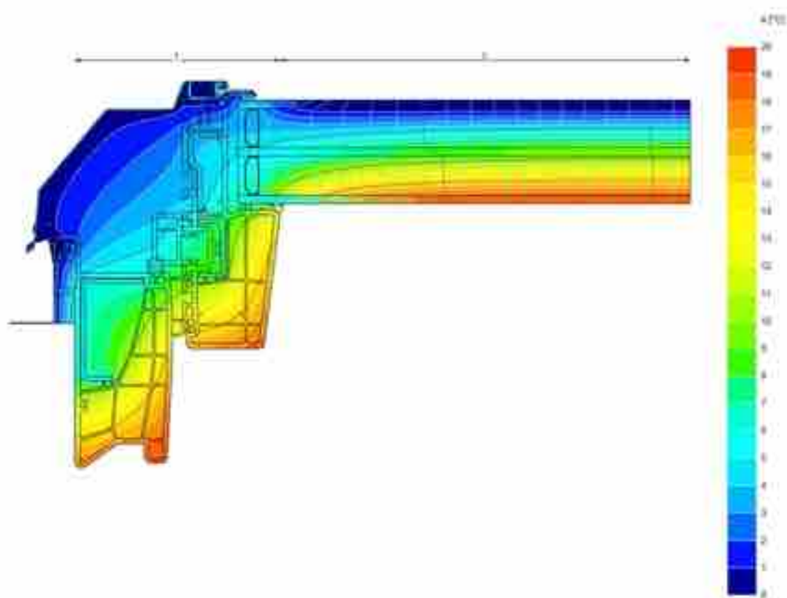
Izotermy, strumień cieplny, temperatury. Przekrój ramy: ościeżnica-skrzydło (B-B)/ szyba zespolona 4|18|4|18|4, ramka aluminiowa, U_g=0,5W/(m^2K) . 1- 95mm, 2 -190mm.
