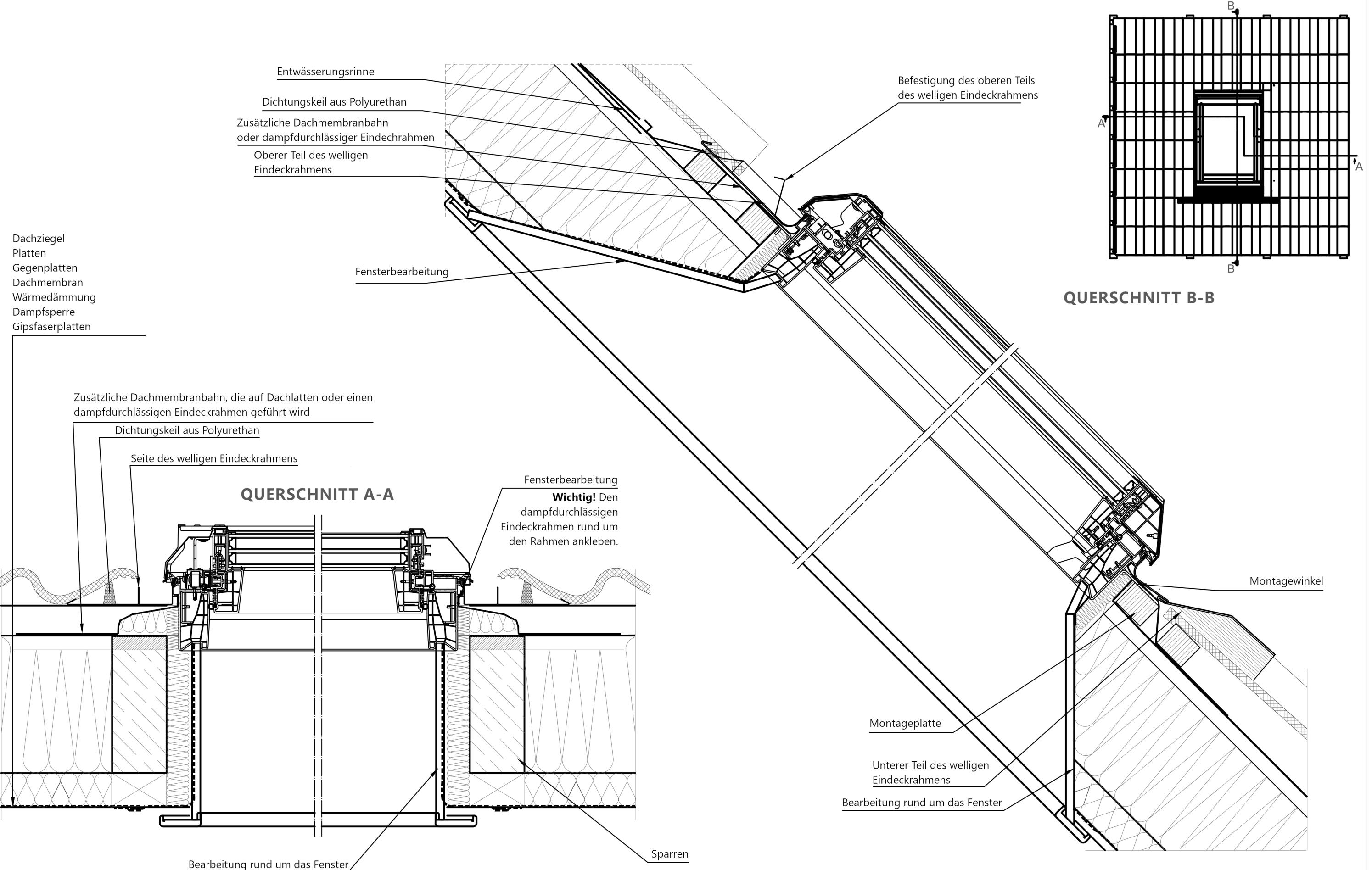
**Vertikaler und horizontaler Querschnitt: Dachfenster Skylight Economic/Supro mit Eindeckrahmen für Welddächer.**
