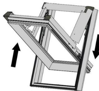
**4 4 Schrauben lösen, die die obere Verblechung an den Stützarmen auf beiden Seiten des Fensters befestigen.**
