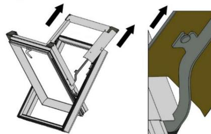
**6 Schutzvorrichtungen (Splinte) von den Stiften der Rahmenhalterung entfernen. Das Flügel vor dem Ausfallen sichern. Die Stützarme von den Stiften schieben, zuerst auf der einen Seite und dann auf der anderen. Das Fenster vorsichtig demontieren.**
