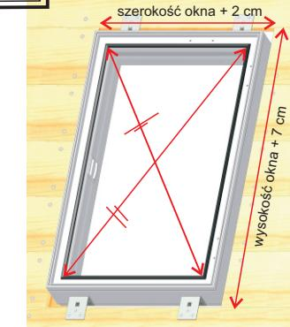
Wyraz dachowy Skylight Premium Loft zamontowany w dachu.
